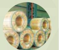
依客戶指定方式，將鋼捲以鋼片、紙板、包裝紙等物品包裝，以達到方便運輸及保護鋼捲之功能。
