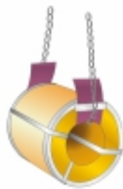
以鏈索穿經鋼捲 中心孔吊運方式 Sling Through Bore
